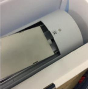
9. Fügen Sie das innere Gehäuse wieder zusammen. Beginnen Sie mit dem Einlegen des inneren Gehäuses so weit rechts wie möglich und schieben Sie diese dann nach links. Jetzt die Schraube wieder festschrauben, um das innere Gehäuse zu fixieren.
