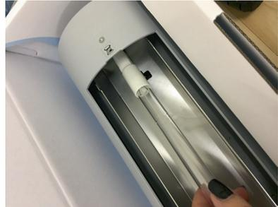
6. Nehmen Sie die neue Leuchte und stecken Sie diese vollständig in den Stecker ein.
