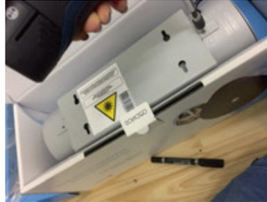
10. Schließen Sie das äußere Gehäuse und schrauben Sie die Schrauben jeweils links und rechts wieder an.
