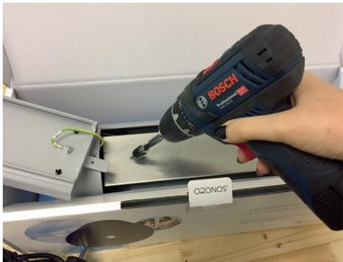
3. Legen Sie das äußere Gehäuse beiseite und schrauben Sie die Schraube des inneren Gehäuses auf.
