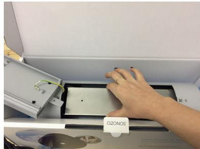
4. Schieben Sie das Gehäuse nach rechts, ziehen es nach oben und legen es beiseite für den späteren Gebrauch.
