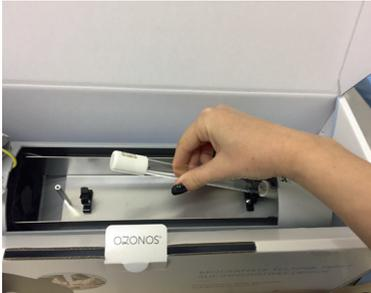
5. Heben Sie jetzt die Leuchte zuerst links, danach rechts aus der Halterung und ziehen Sie die Leuchte vorsichtig aus dem Stecker.
