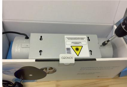
2. Schrauben Sie die zwei Schrauben mit einem Torx 10 -Schraubenzieher auf.
